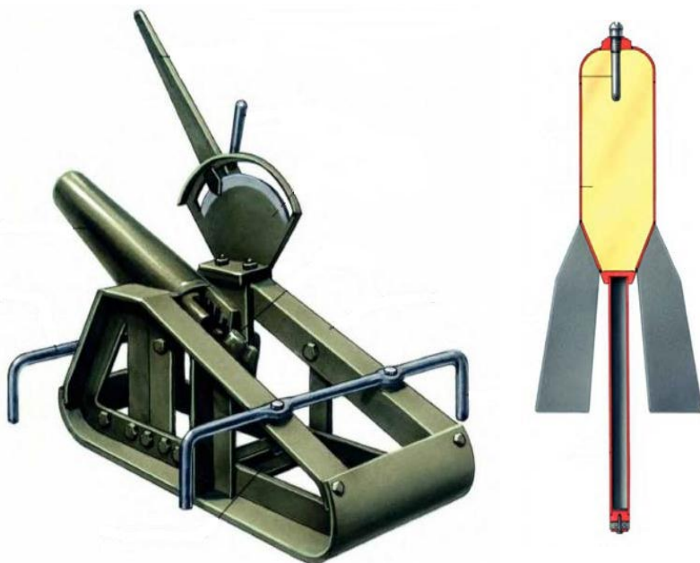
Рис. 1.1. 58-мм міномет зразка 1915 року конструкції Є.А. Ліхоніна
