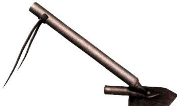
Рис. 1.3. 37-мм міномет-лопата Дьяконова зразок 1938 р.
